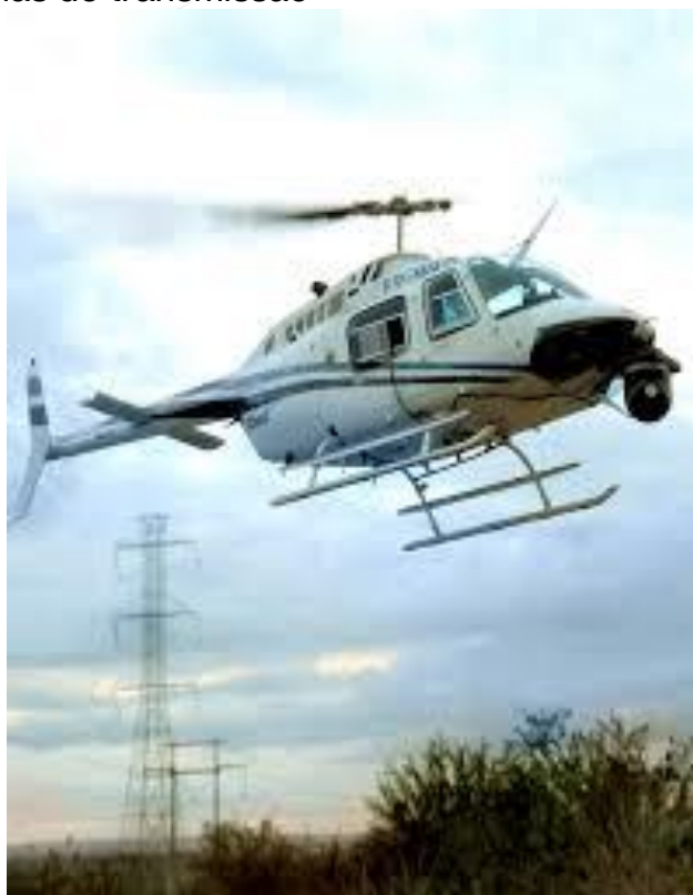
Figura 12 – Helicóptero da CHESF utilizando Gimbal 5 para inspeção de linhas de transmissão
