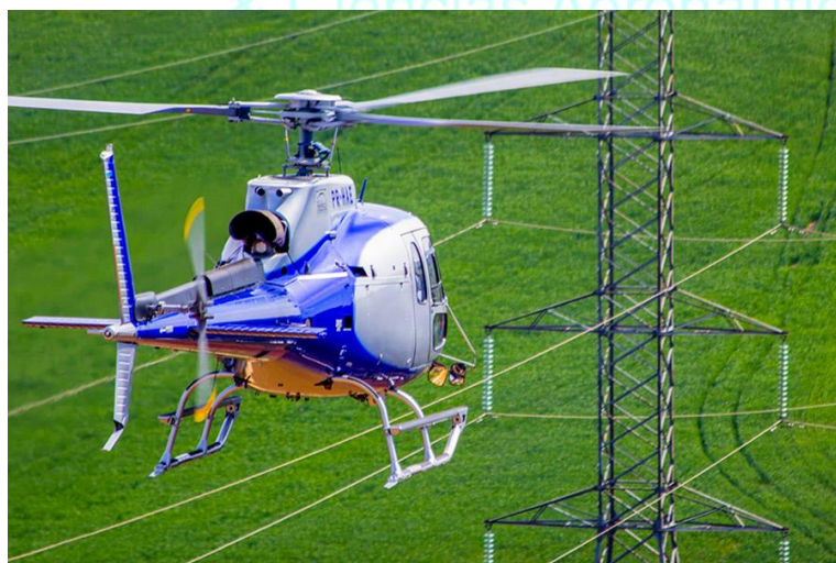
Figura 2 - Helicóptero realizando inspeção de linha de transmissão
