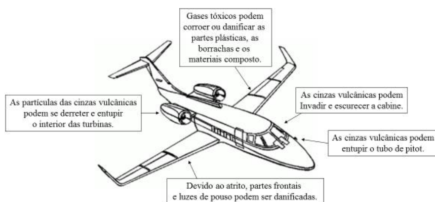
Figura 3 – Danos causados pelas cinzas vulcânicas
