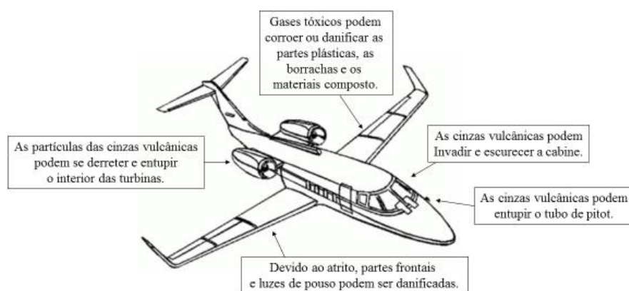
Figura 3 – Danos causados pelas cinzas vulcânicas
